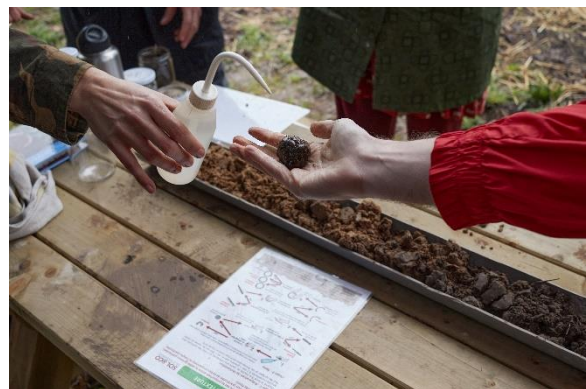
fig. 8 - mesure de la texture de la terre (Labo mobile des sols)
