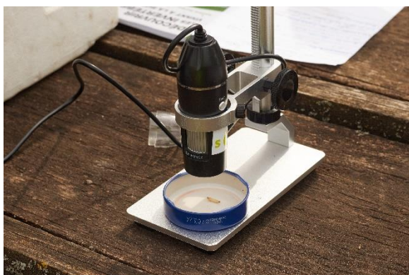
fig. 9 - loupe numérique pour l'observation et l'identification de la microfaune des sols (Labo mobile des sols)
