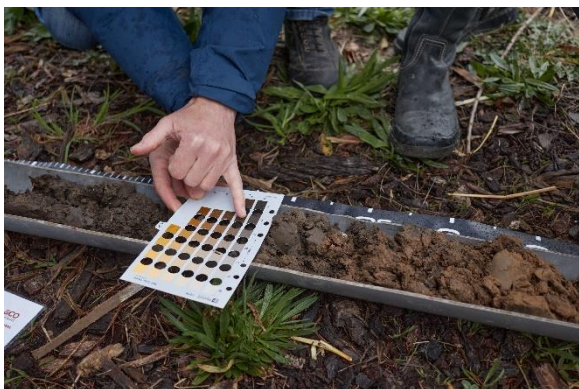
fig. 7 - mesure de la couleur de la terre (Labo mobile des sols)
